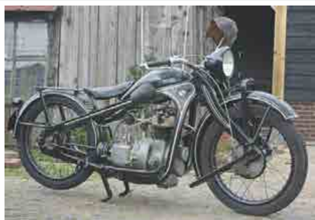
• BMW R2 uit 1931 met een enkele cilinder van 198 cc.
